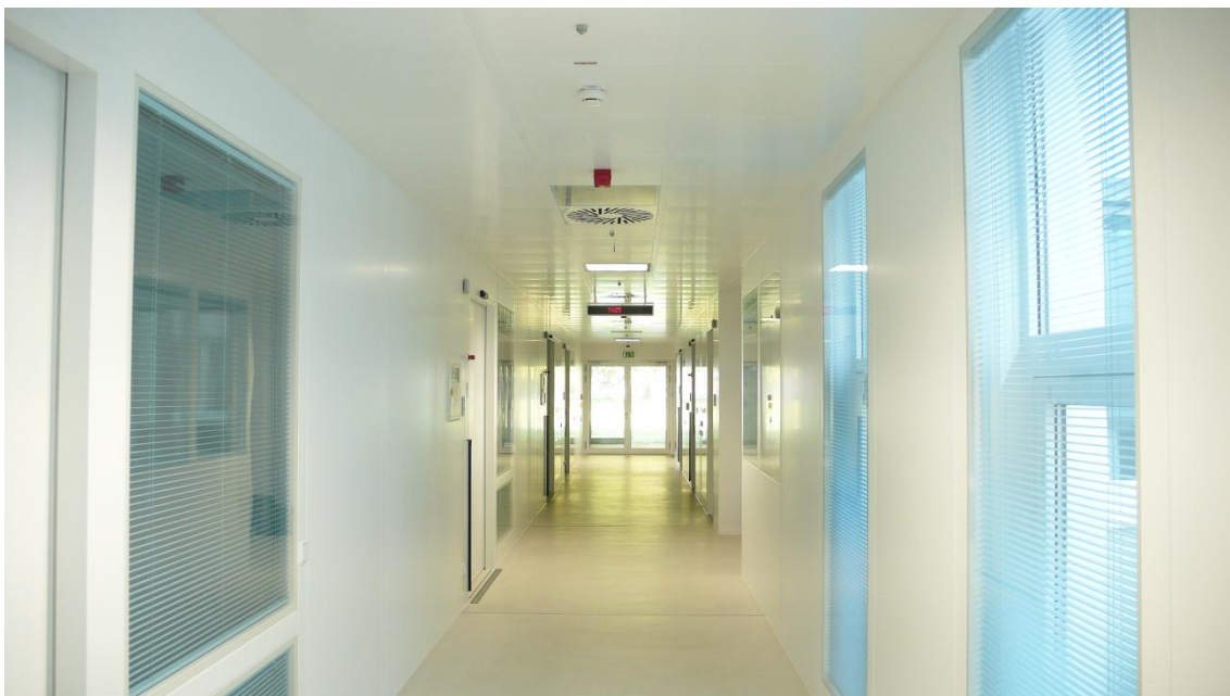
Reinraumwände Typ WS8 B/P mit Mittellichtelementen und elektrischen Jalousien
